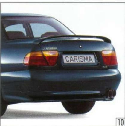
**Hinweis:** Die serienmäßige dritte Bremsleuchte ist bei Verwendung eines Spoilers mit integrierter Bremsleuchte durch vollständiges Entfernen oder durch Abkleben und Entfernen der Glühbirne funktionsunfähig zu machen.
